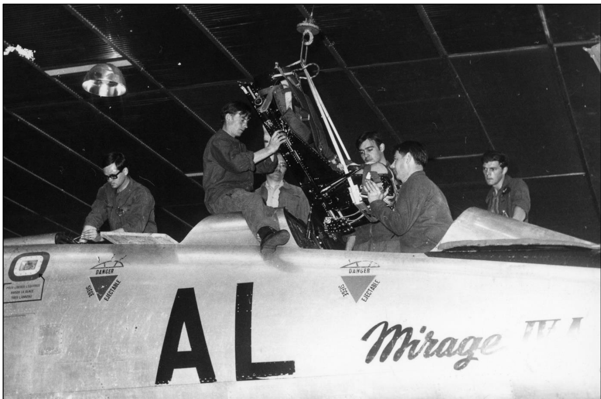
Mécaniciens de l'EB 3/94 Arbois procèdent au changement du siège éjectable au poste pilote sur le Mirage IV A n°13 Photo DR/Coll. G. Coulon
