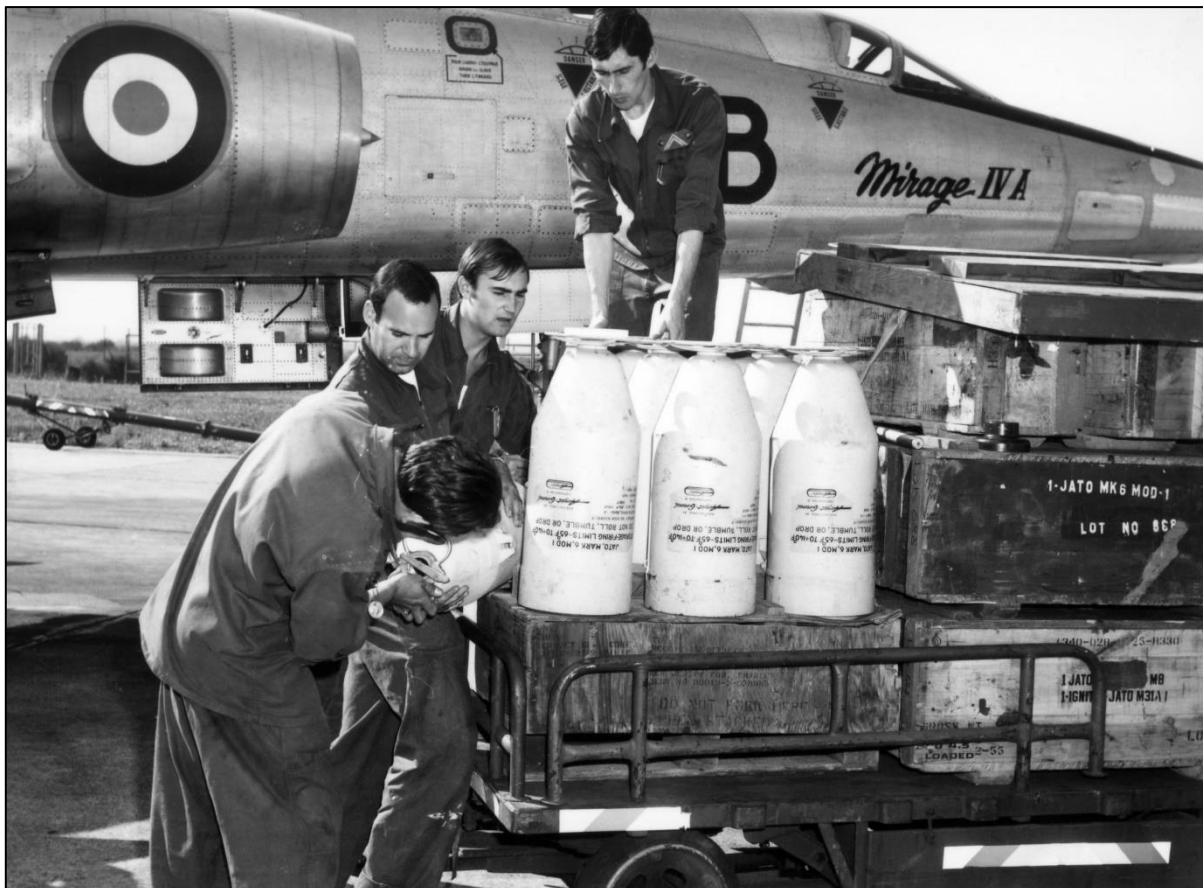
Mécaniciens et armuriers préparent 6 fusées JATO avant leur montage sous un Mirage IV A Photo DR/Coll. G. Coulon
