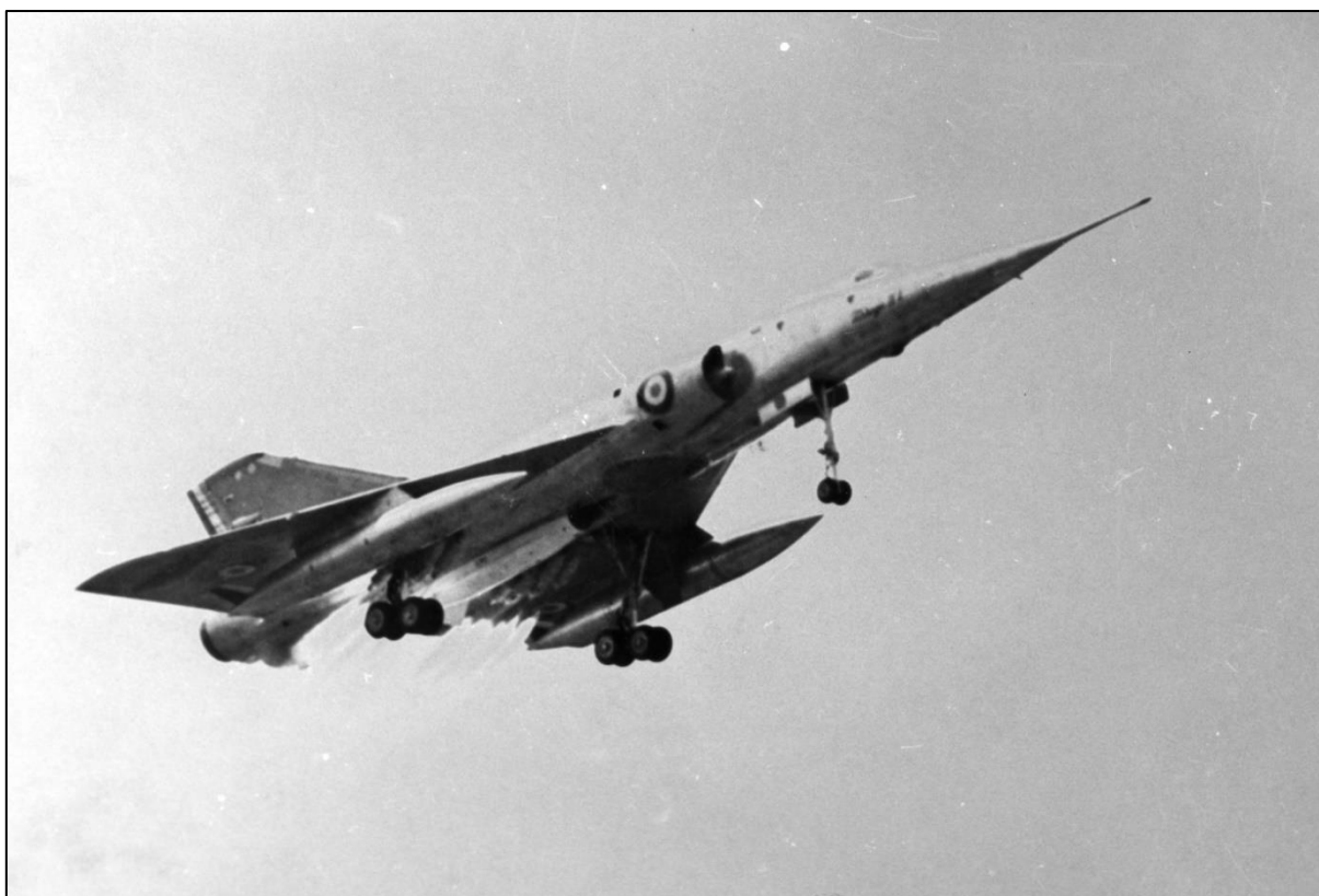
Décollage JATO d'exercice pour un Mirage IV A non codé, en configuration lourde avec une maquette de bombe AN 21 et des réservoirs de 2 500 l Photo DR/Coll. G. Coulon
