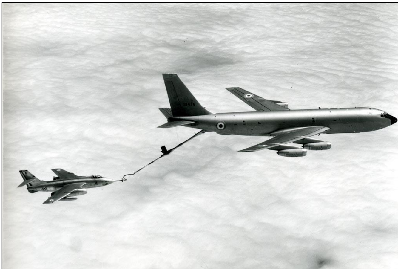
Le C-135 F s/n 63-8475, livré en juin 1964, ravitaille le Vautour n°4 doté d'une perche de ravitaillement en vol pour l'entraînement. Photo DR/Coll. ANFAS.
