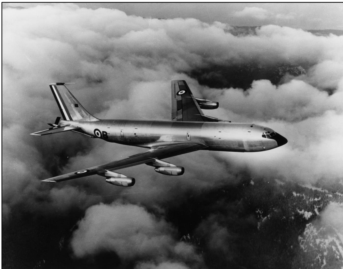
Le prototype du C-135 F en vol aux Etats-Unis avec des marquages français, le haut de dérive, tronqué à l'arrière, n'est pas encore la version définitive.
