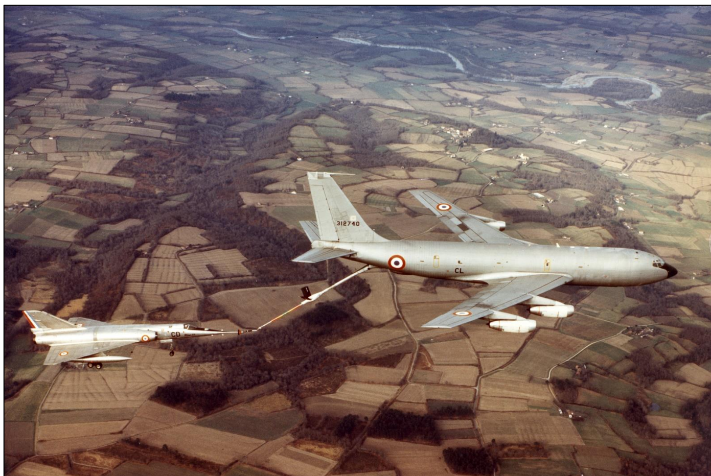
Trains sortis, le Mirage IV A n°57 CD ravitaille à moyenne altitude sur le C-135 F s/n 63-12740, code CL. Photo DR/Coll. H. Beaumont.
