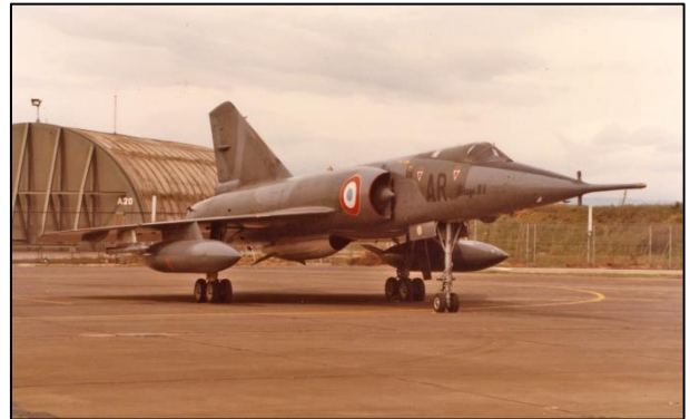
Le Mirage IV A n°19 en configuration nucléaire avec des réservoirs de 2 500 l, une maquette de la bombe AN 21 en point ventral et avec un conteneur lance paillettes Phimat aux points 2 sous voilure Crédits : DR/Coll. H. Beaumont.
