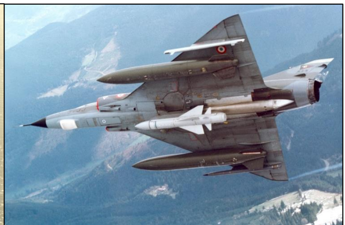
Le Mirage III E n°264 de l'EC 2/3 Champagne en configuration mission anti radar avec un missile AS 37 Martel en point ventral Crédits E. Moreau.
