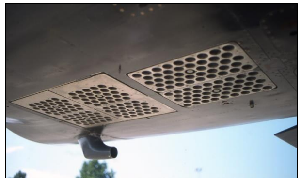
Lance leurres ALKAN F1 pouvant contenir 104 cartouches de leurres EM et 84 cartouches de leurres IR, sous le croupion d'un Mirage IV P Crédits H. Beaumont.
