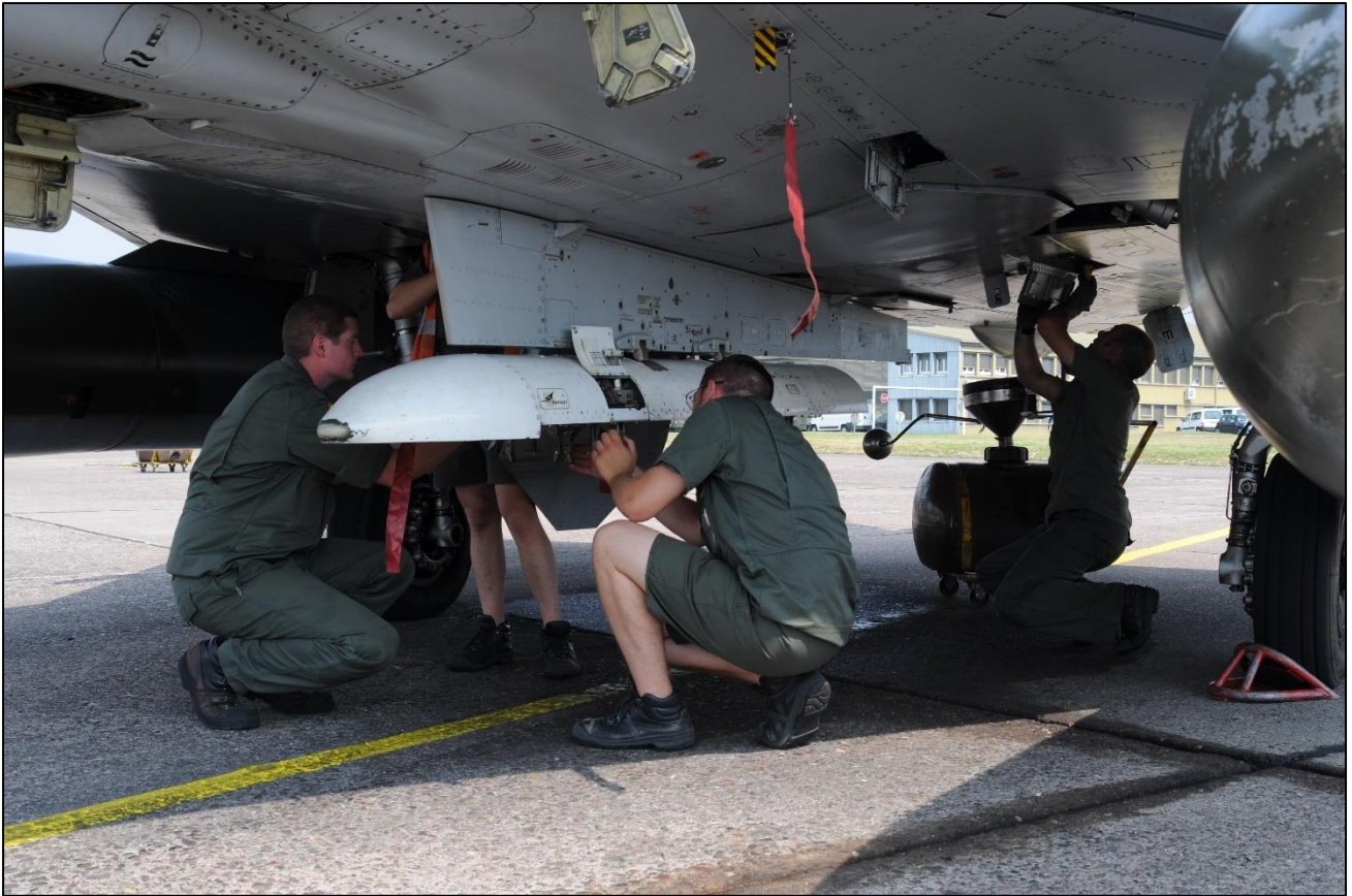
Crédit Photo : H. Beaumont. Armement d'un lance-bombes Rafaut avec des bombes d'exercice sous un Mirage 2000 N.
