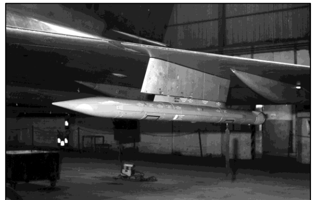
Lance paillettes Phimat au point 2 sous voilure d'un Mirage IV A Crédits : DR/Coll. H. Beaumont.
