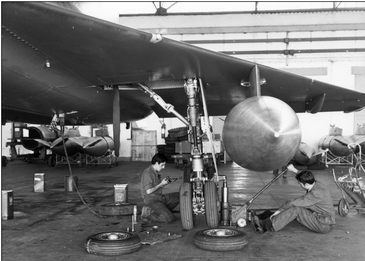
Crédit Photo : DR/ Coll. H. Beaumont. Mécaniciens procédant à un changement des roues du train principal d'un Mirage IV A.
