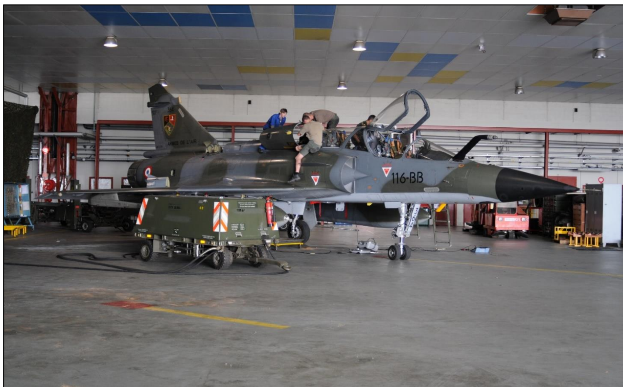
Crédit Photo : H. Beaumont. A Luxeuil, des mécaniciens de l'EC 2/4 « La Fayette » procédant à une remise en œuvre du Mirage 2000 N n°364.
