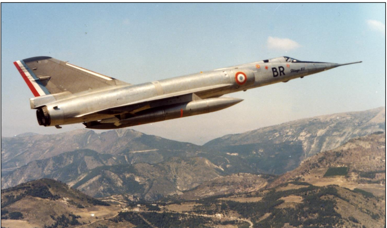
Photo B. Regnier : Le Mirage IV A n°45 à moyenne altitude au-dessus des Alpes du Sud, emportant des réservoirs de 2 500 l et une bombe AN 21 d'exercice.
