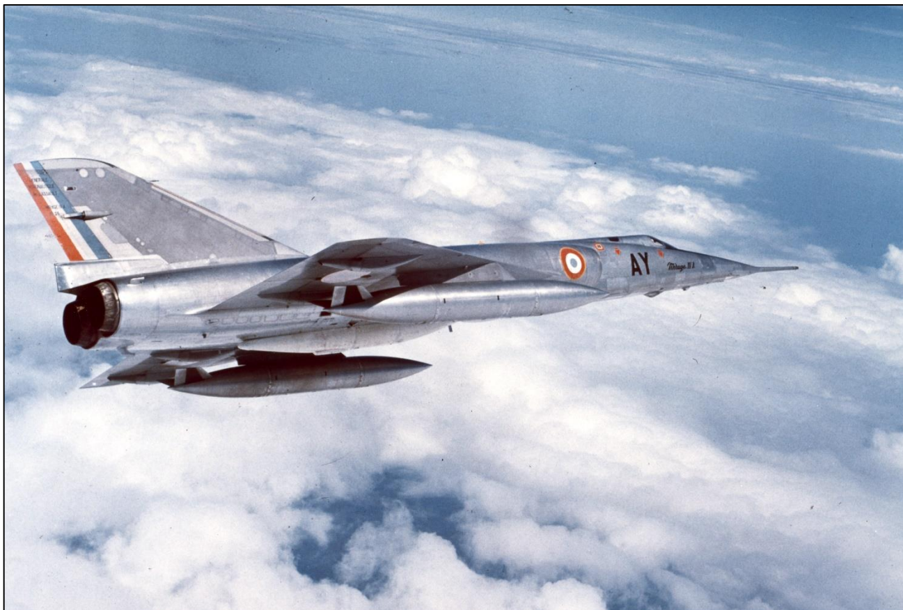
Photo DR/Coll. Beaumont : Le Mirage IV A n°26 au-dessus de la couche, emportant des réservoirs de 2 500 l et un réservoir RS 21 de 1 600 l en point ventral.
