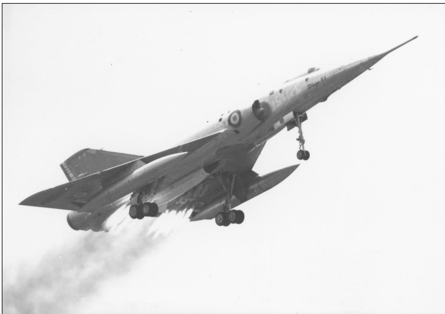
Photo DR/Coll. Mermet : Le Mirage IV A n°51, non codé, en configuration lourde emportant des réservoirs de 2 500 l et une bombe AN 21 d'exercice lors d'un décollage assisté par fusées JATO.
