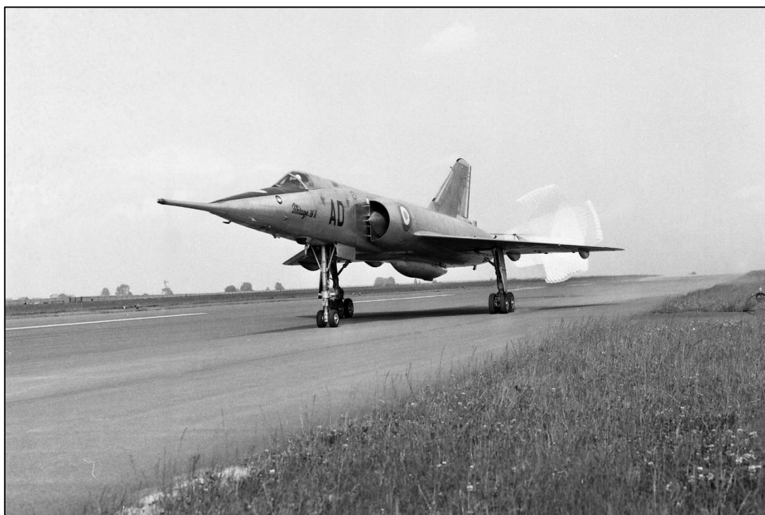
Photo DR/BA 103 : Parachute frein déployé, le Mirage IV A n°5 au retour d'une mission, équipé d'un réservoir ventral RS 21 de 1 600 l.
