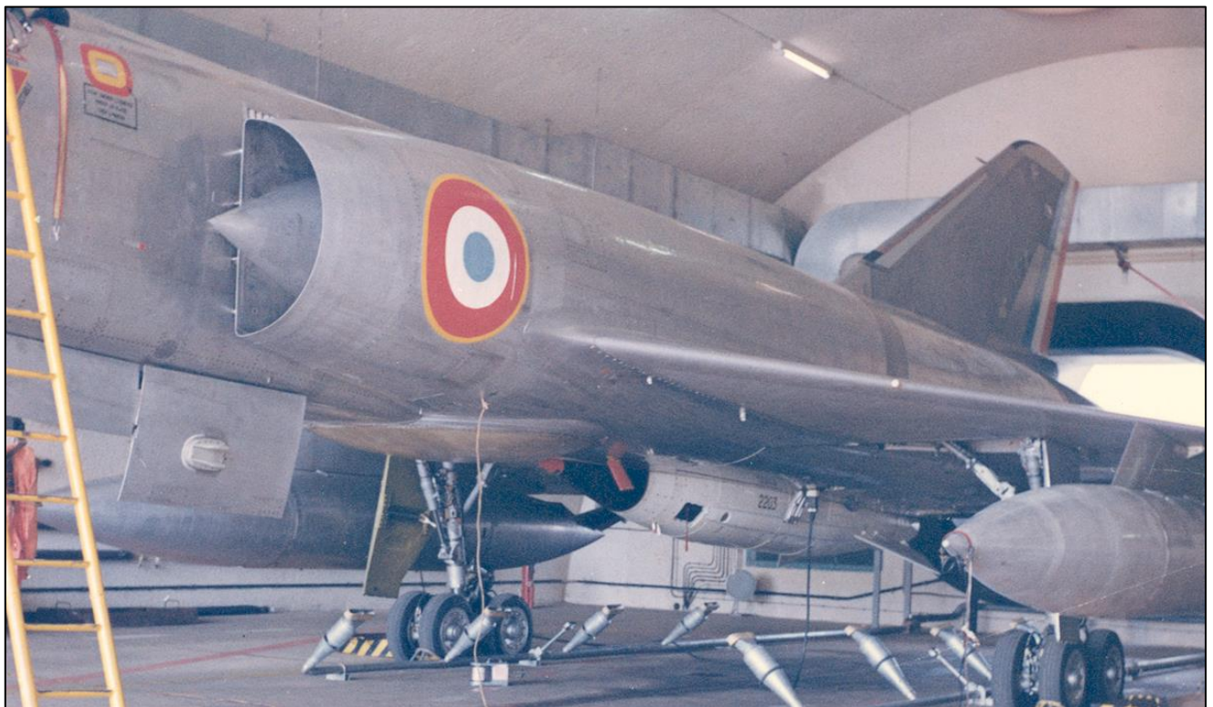
Photo DR/Coll. Beaumont : Sous une hangarette en zone d'alerte, une bombe AN 21 d'exercice en point ventral sous un Mirage IV A. A noter au sol, les rampes anti incendie, disposées de part et d'autre de l'arme.
