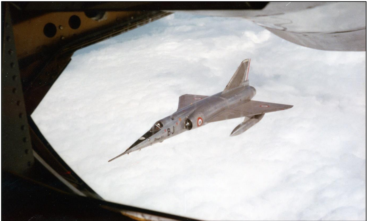
Photo DR/Coll. Mermet : Le Mirage IV A n°37, en position perche droite avant un ravitaillement en vol, équipé de réservoirs de 2 500 l.
