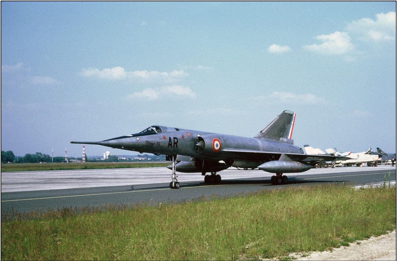
Photo DR/Coll. Beaumont : Le Mirage IV A n°19 au roulage pour un départ en mission, équipé de réservoirs de 2 500 l et d'une bombe AN 21 d'exercice en point ventral.
