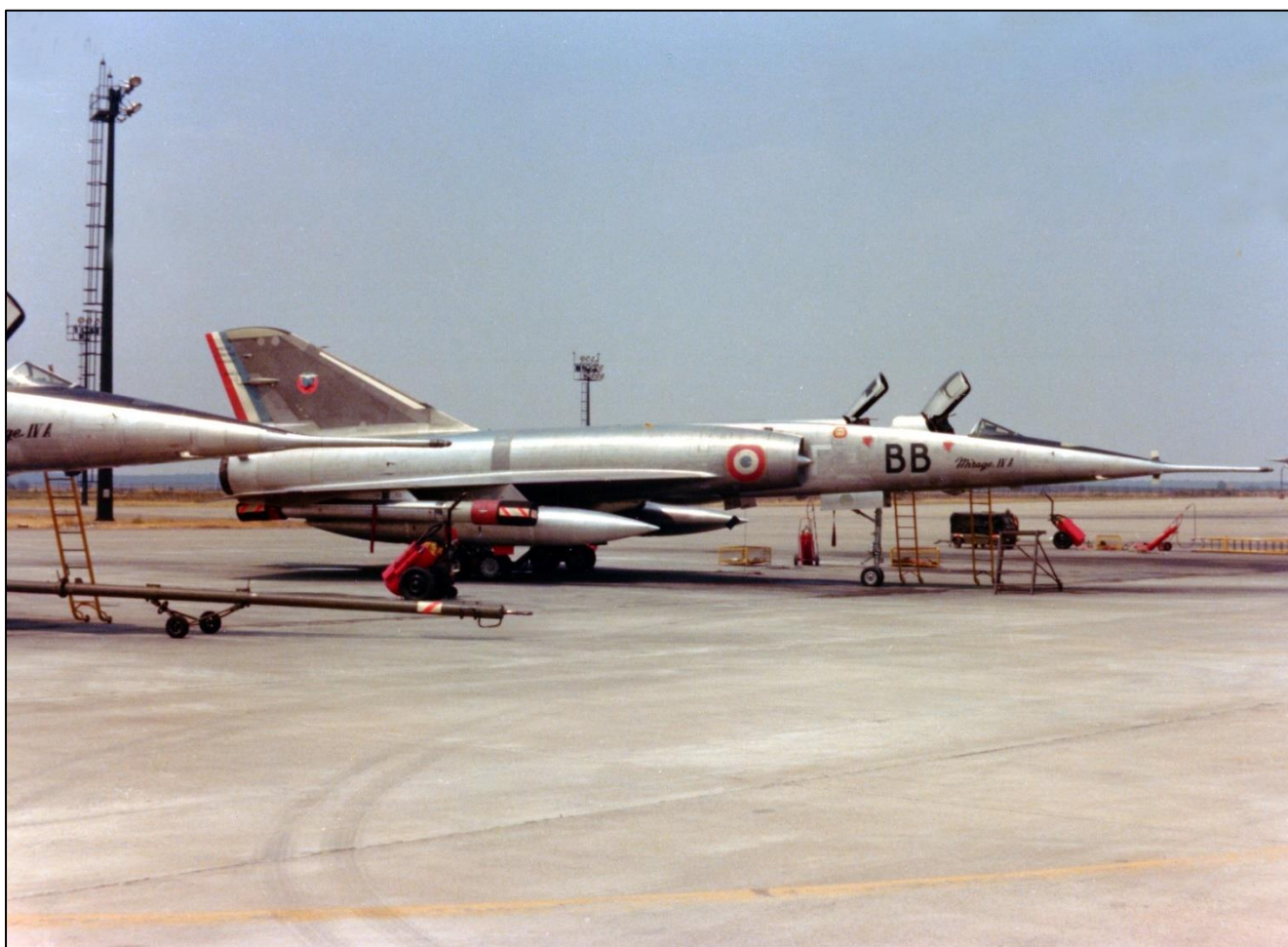
DR/Coll. Mermet : A Avord, le Mirage IV A n°29 portant sur sa dérive l'insigne de l'escadron de bombardement 3/91 Beauvaisis. L'avion était équipé de réservoirs de 2 500 l et de conteneurs de guerre électronique CT 51 dont les pointes avant et arrière étaient recouvertes d'une protection.
