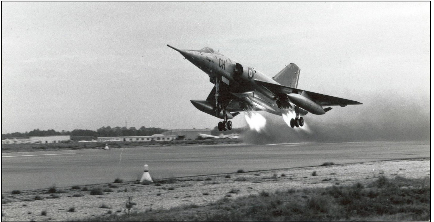
Photo DR/Coll. Beaumont : A Bordeaux Mérignac, le Mirage IV A n°61, configuré avec des réservoirs de 2 500 l au cours d'un décollage JATO.
