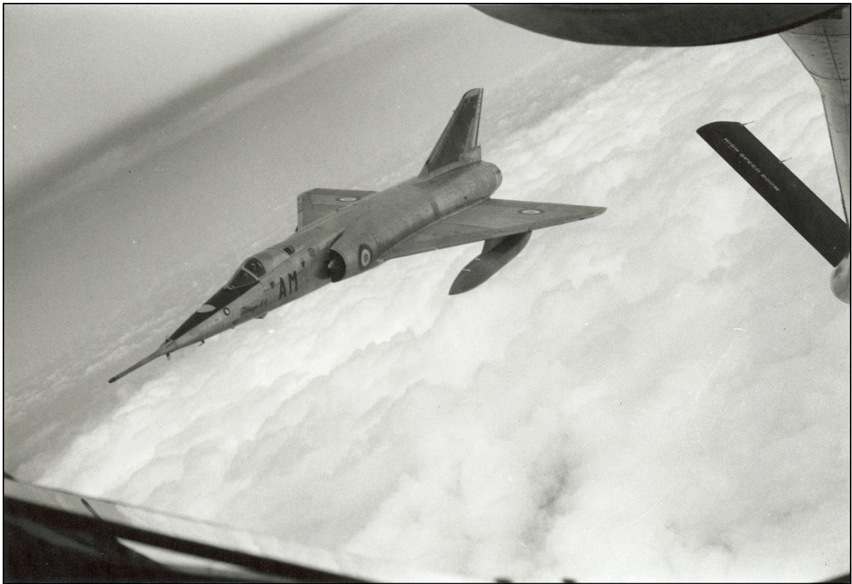
Photo DR/Coll. Beaumont : En position perche droite avant un ravitaillement en vol, le Mirage IV A n°14, emportant des réservoirs de 2 500 l.
