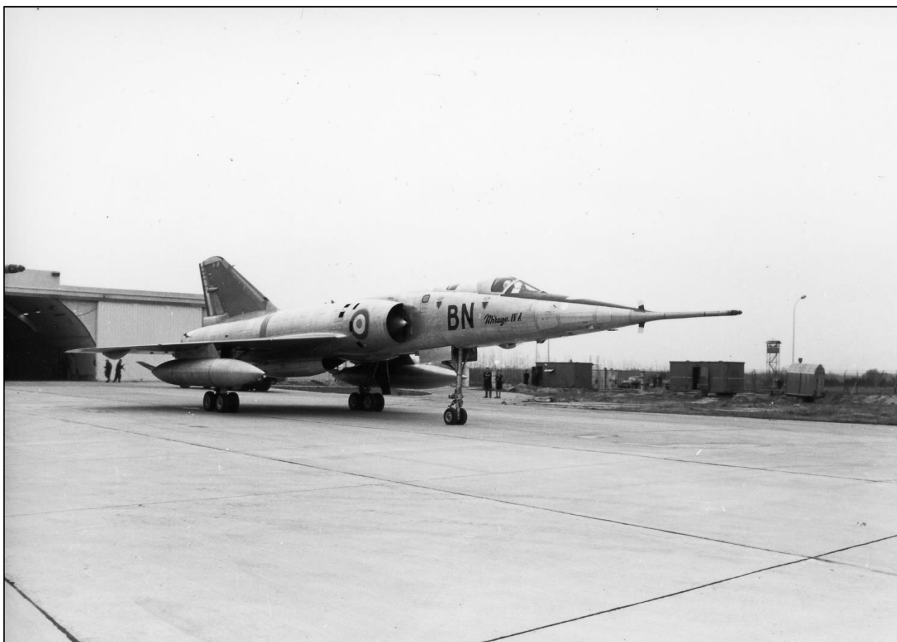
DR/Coll. Beaumont : Le Mirage IV A n°41 sortant d'une hangarette dans la zone d'alerte, emportait des réservoirs de 2 500 l et une bombe AN 21 d'exercice en point ventral.
