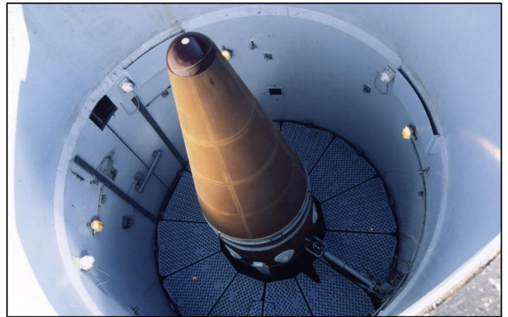
Photo DR/CFAS : La tête d'un missile SSBS S3 dans son silo, entourée des plateformes mobiles en position abaissée, qui permettaient de procéder aux interventions techniques.
