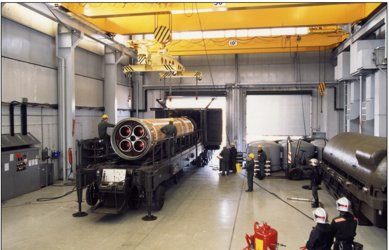
Photo DR/CFAS : Sous la surveillance de pompiers prêts à intervenir, des mécaniciens procédaient au transfert d'un SSBS S3 dans le caisson d'un véhicule de transport éracteur.
