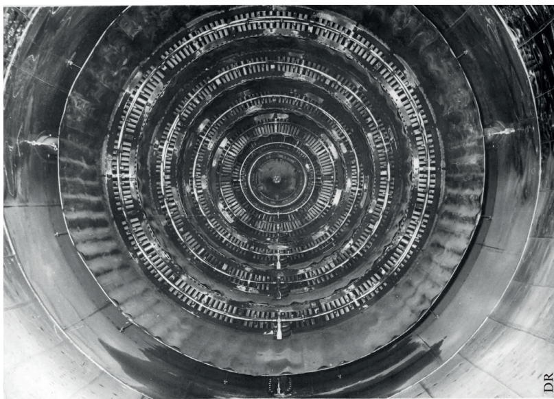
La tuyère du Leduc 016 avec les chambres concentriques.
